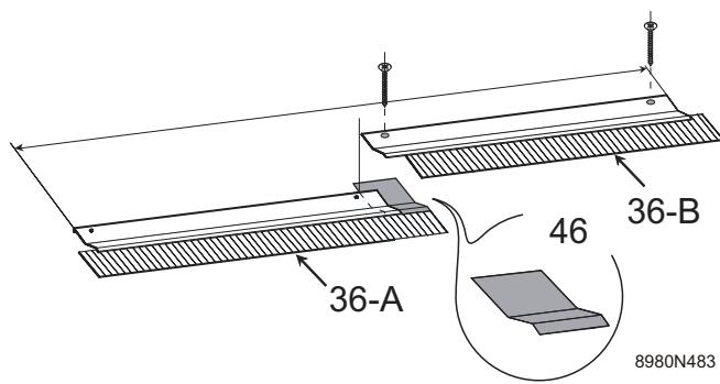
Markeer het linker uiteinde op de TRI rechts, verwijder de beschermfilm van het butyltape van de TRI rechts en plaats de TRI terug.
