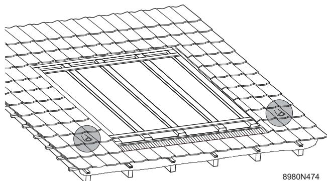
*i* La teja de ventilación debe ser lo suficientemente amplia para que puedan pasar los tubos de conexión con el aislamiento térmico incluido.
