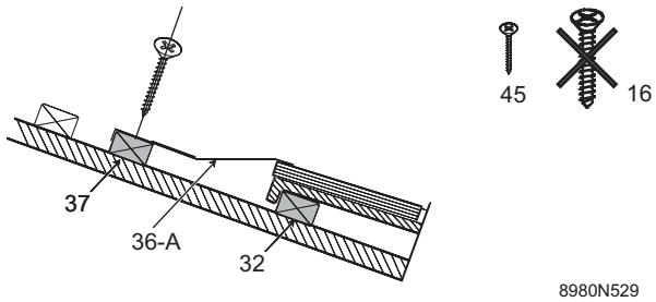
Fissare la TRI di sinistra sul listello di montaggio (37) per mezzo di viti piccole 3.9x25 (45).
