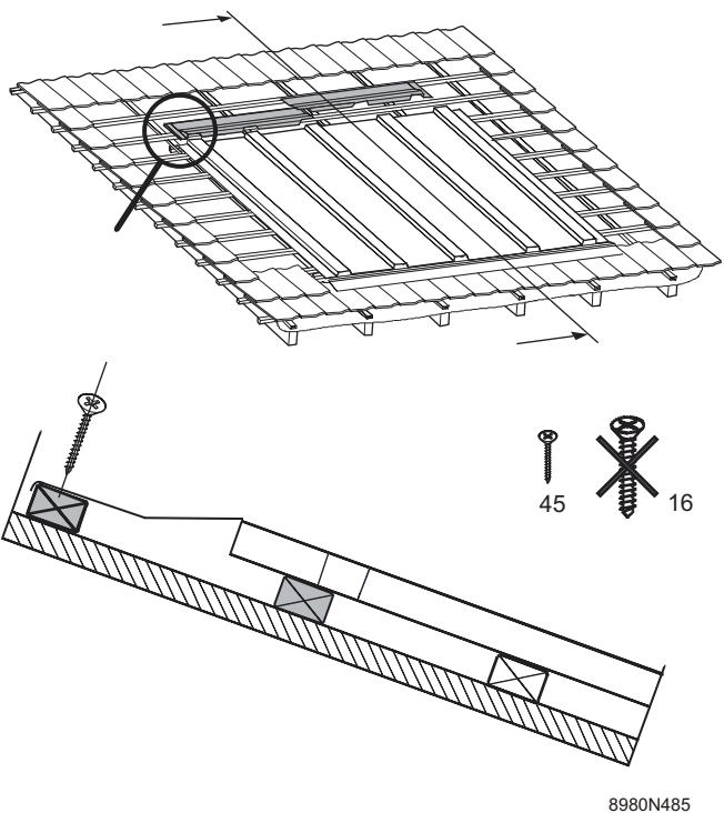
15. Schuif het loden onderdeel (46) half onder de rechterraand van de TRS. Het onderste deel moet op gelijke hoogte liggen met het loden schutblad van de TRS. Het bovenste deel moet tegen de montagelat liggen.
