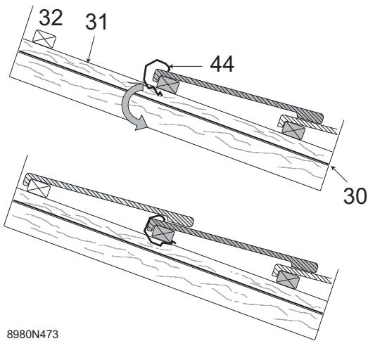
Si es necesario, corte la hilera de tejas de la derecha. Habrá que retirar las espigas de suspensión situadas en el borde de la chapa en las hileras de tejas adyacentes al sistema de montaje integrado en el tejado.
