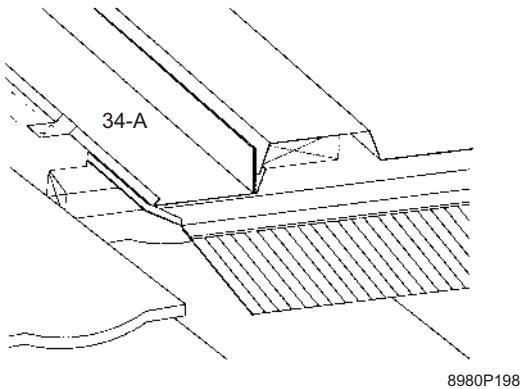
13. Zet de TRL (34-A en 34-B) vast met buitenste opstaande rand op de daklat met behulp van de bevestigingsbeugels (41).
