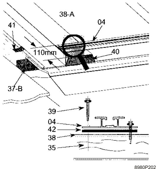
Compruebe la posición de los obturadores (40) y fije el perfil de base (04) sobre el tablero de montaje (37) pasando tornillos estancos (39) por los agujeros previstos para tal fin.
