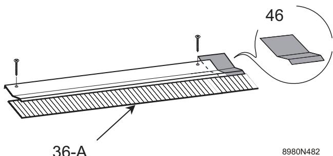
Controleer de stand van de TRI links (36-A) en zet deze daarna vast op de montagelat (37) met behulp van een 2e schroef 3,9 x 25 mm (45).
