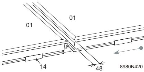
Ajuste la posición del captador plano de manera que las patas de fijación estén alineadas con los bordes izquierdos de los perfiles base. Monte las patas de fijación en los perfiles base con un tornillo hexagonal atornillado a los calzos de corredera.
