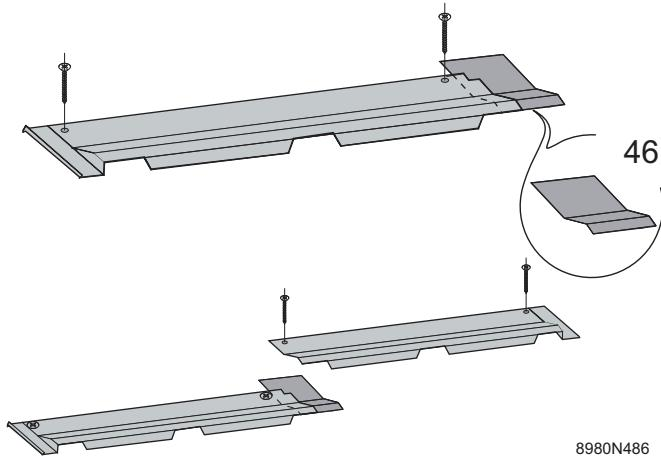
Verificare l'orientamento della TRS di sinistra (33-A), quindi fissarla sul listello di montaggio (37) mediante una seconda vite 3,9 x 25 mm (45).
