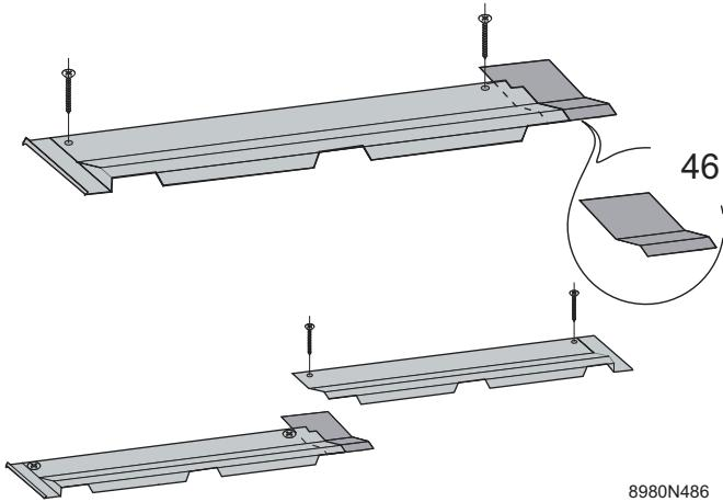
Controleer de stand van de TRS links (33-A) en zet deze daarna vast op de montagelat (37) met behulp van een 2e schroef 3,9 x 25 mm (45).
