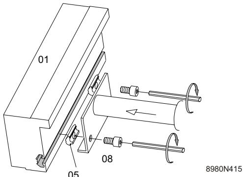
**i** Montare le maniglie di manutenzione in modo che una persona possa trasportare il pannello tenendolo da un solo lato.
