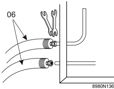
**⚠** Houd de biconische wartels bij het vastzetten tegen, zodat de wartels van het zonnepaneel niet beschadigen.
