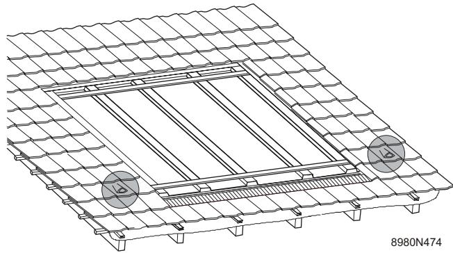
**i** De doorvoerdakpan moet breed genoeg zijn om de verbindingslussen, inclusief de thermische isolatie, door te laten.
