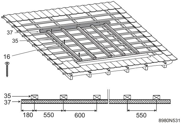
8. Per la posizione verticale dei listelli di montaggio, rispettare le indicazioni della figura seguente.
