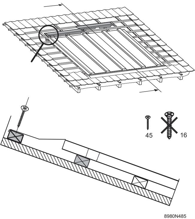
15. Deslice la pieza de plomo (46) hasta la mitad del borde derecho de la CRS. La parte inferior debe colocarse al mismo nivel que la placa protectora de plomo de la CRS. La parte superior debe colocarse contra el listón de montaje.
