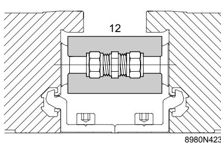
Isolare gli altri collegamenti idraulici nello stesso modo.
