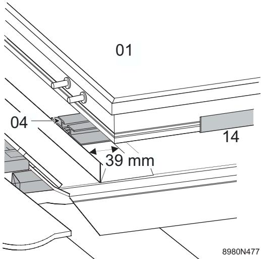
Desmonte los asideros de manipulación del primer captador y colóquelos en el segundo captador.
