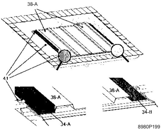
14. Plaats de bovenste afdekplaat (TRS) links (33-A) op de bakken (38-A en 38-B) en op de TRL door hem links in lijn te brengen en naar beneden te schuiven zodat de opstaande rand goed tegen de montagelat (37) aanligt. Zet vast op de montageplank met een kleine schroef (45).
