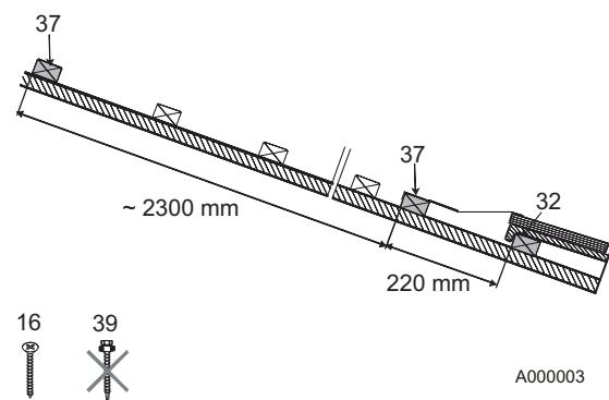
**i** Utilizzate le viti 6x70 (16) per fissare i listelli di montaggio. Non utilizzare viti a tenuta stagna (39).
