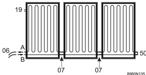
06 Kit de conexión de los captadores solares
