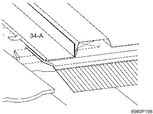
13. Fissare le TRL (34-A e 34-B) mediante gli spigoli esterni sui listelli del tetto servendosi delle staffe di fissaggio (41).
