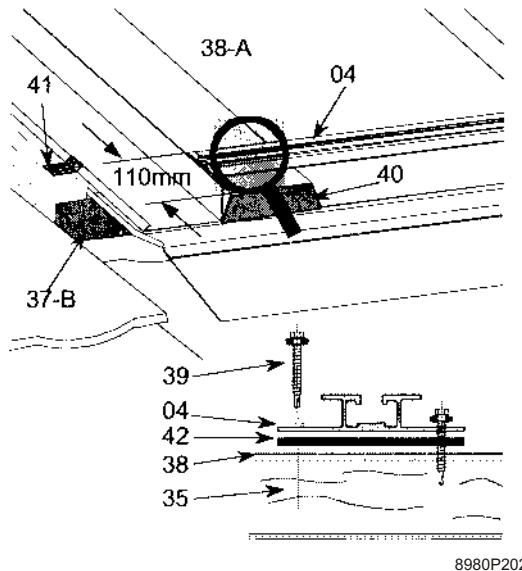
Controleer de stand van de afsluitstukken (40) en zet het basisprofiel (04) vast op de montageplank (37) met waterdichte schroeven (39) door de hiervoor bestemde gaten.
