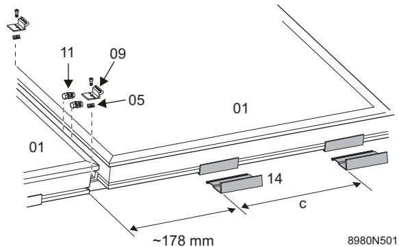
Posizionare un blocchetto di ancoraggio (05) in ciascun binario di base (04) e posizionarlo in modo che le staffe di fissaggio (09) del secondo pannello possano successivamente essere fissate contro quelle del primo.
