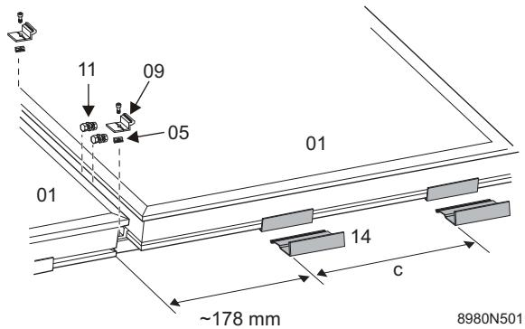
Coloque un calzo de corredera (05) en cada perfil base (04) y póngalos de manera que las patas de fijación (09) del segundo captador puedan fijarse a las del primero.
