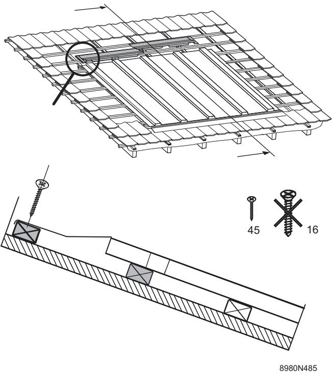
15. Far scivolare la parte in piombo (46) a metà sotto il bordo dritto della TRS. La parte inferiore deve posizionarsi allo stesso livello del grembiule di protezione in piombo della TRS. La parte superiore deve posizionarsi contro il listello di montaggio.
