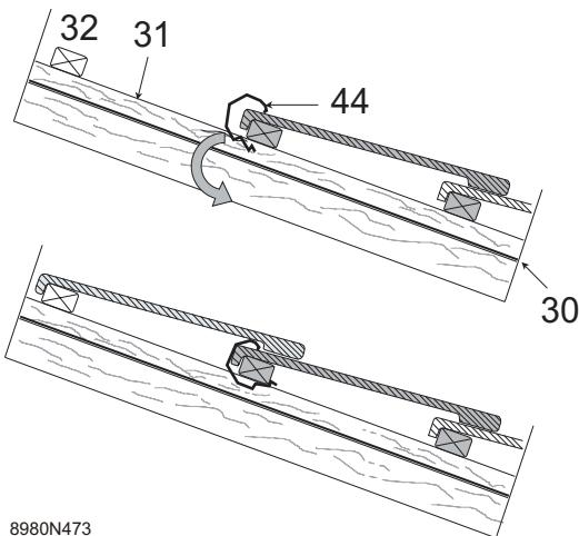
Se necessario, tagliare la fila di tegole di destra. E' necessario rimuovere i perni di sospensione situati accanto alla tegola nelle file di tegole adiacenti al sistema di montaggio ad integrazione del tetto.
