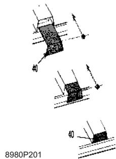
**i** Het bevestigen gebeurt later door het vastschroeven van de basisprofielen.
