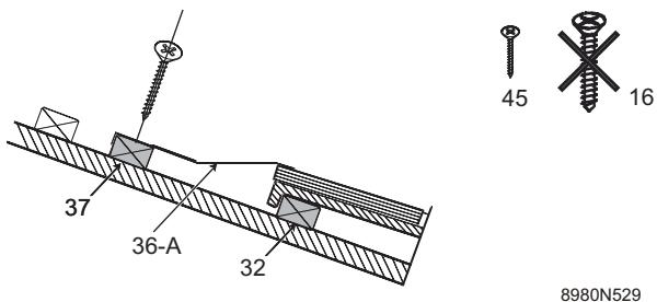
Zet de TRI links vast op de montagelat (37) met behulp van de kleine schroeven 3.9x25 (45).
